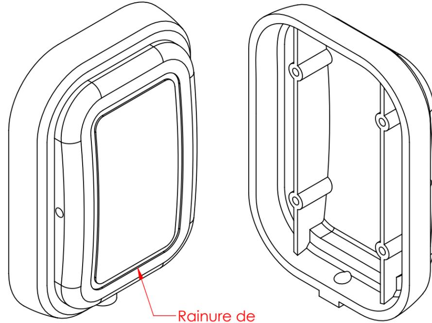
Rainure de 0,5mm de profondeur voir vue de dessus pour détails
